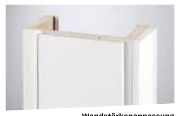
Wandstärkenanpassung Ausziehbare Zierbekleidung ermöglicht Unebenheiten in der Mauer bis zu +20 mm auszugleichen.
