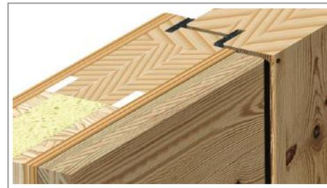
Detail: Standard-Türblatt Rohling mit Massiv-Altholz Applikation
